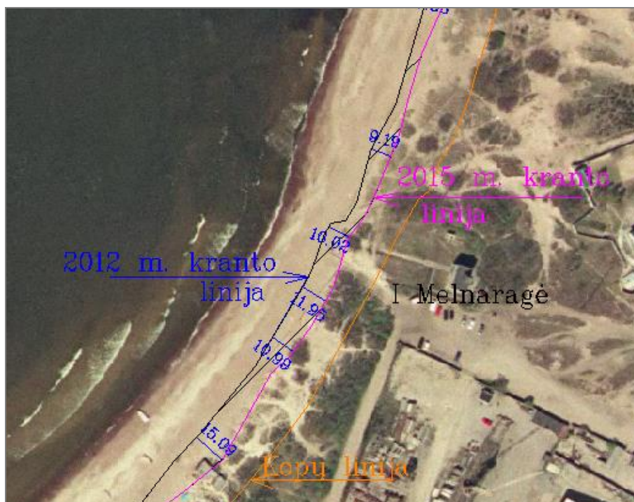
4 pav. 2012 ir 2015 m. sausio mėn. laikotarpio Baltijos jūros kranto poslinkis Fig. 4. Displacement of the Baltic Sea coast in the period of January 2012 and 2015
